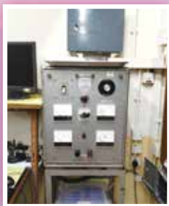
實驗室內的「低電壓實驗功率裝置」已老化得不能運作了
